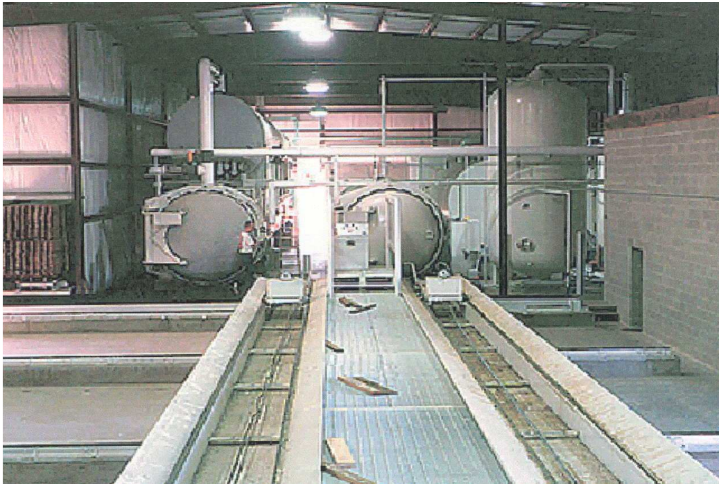
Joonis 3.6. Immutusseade töötamiseks meetodil surve-surve-vaakum
