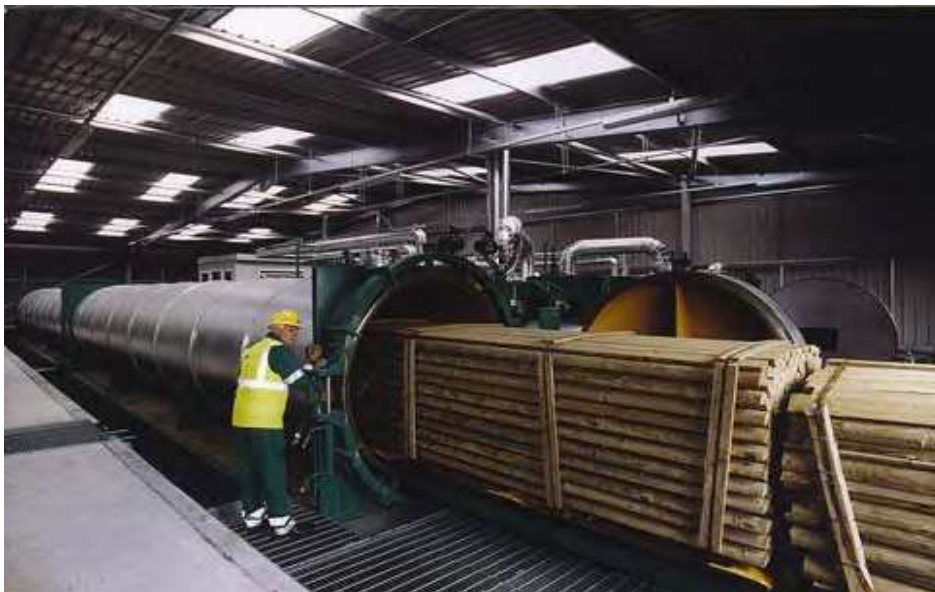
Joonis 3.3. Autoklaavi täitmine puiduga
